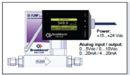
図6-2. 指示調節計 (Bright) 接続例
